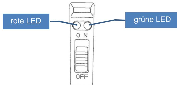
Wenn die Batterie-Spannung ausreichend ist, leuchtet die grüne LED dauerhaft. Wenn die Spannung sinkt wird die grüne LED dunkler und die rote LED leuchtet auf. In solch einem Fall, erneuern Sie die Batterie innerhalb einer Stunde.
