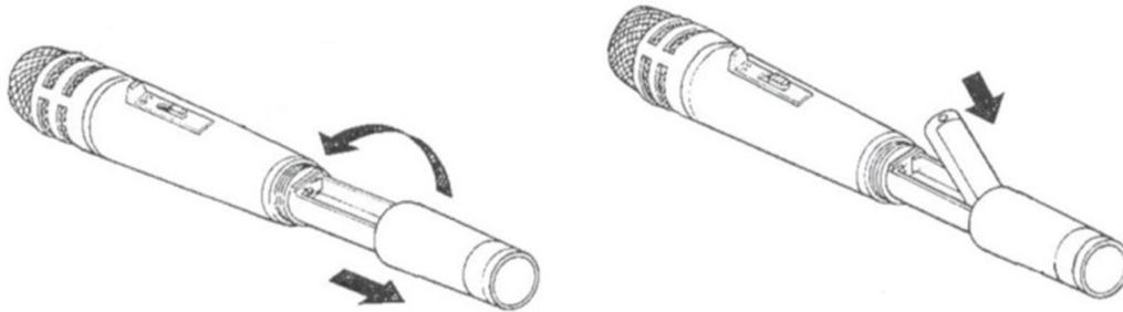
Der Handsender benötigt 1 Stück "AA" - Batterie. Bitte drehen Sie das Batteriefach auf und setzen Sie dann die Batterie ein. Achten Sie bitte genau auf die markierte Polarität.
